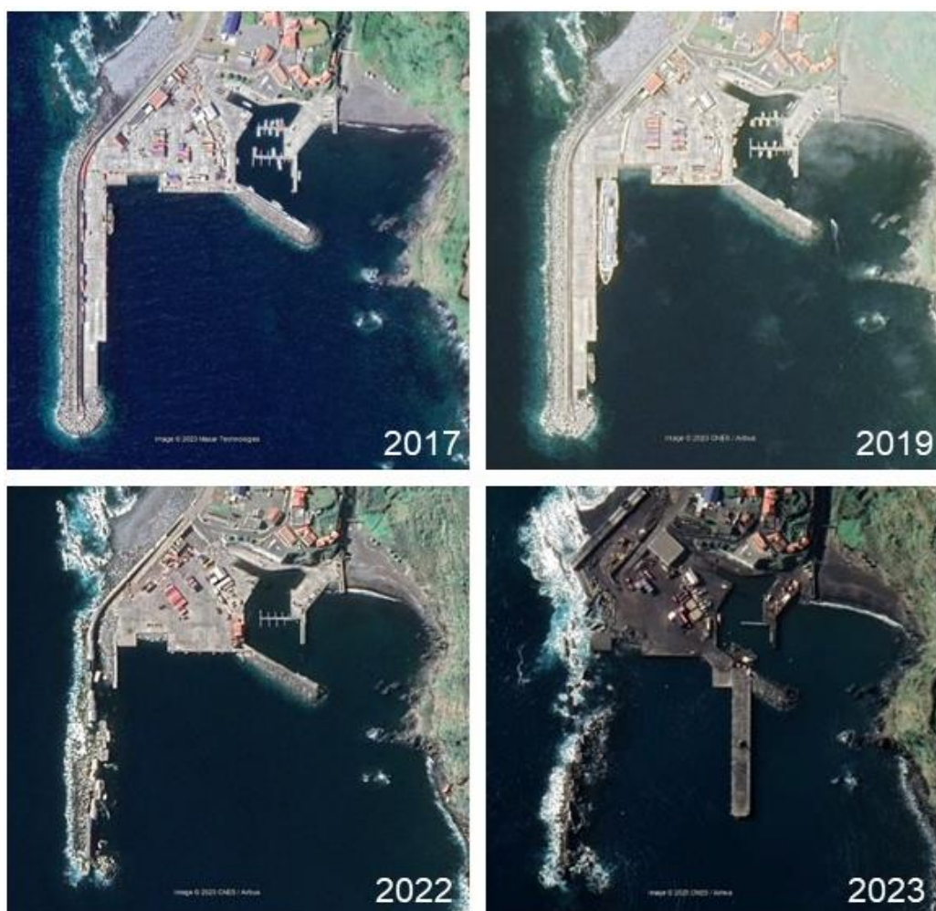
Figura 66. Imagens de satélite do porto das Lajes das Flores entre 2017 e 2023, mostrando os danos provocados pela Tempestade Carlos (novembro 2018), o Furacão Lorenzo (outubro 2019) e a Depressão Efrain (dezembro 2022) (Fonte: Google Earth)
